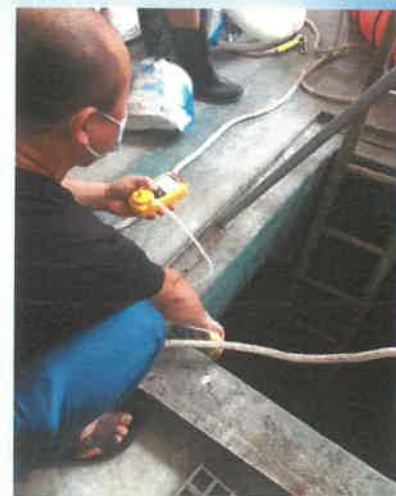
用气体检测仪检测池内气体浓度
